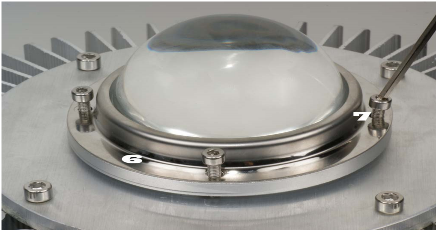
Abb. 2: Schrauben (7) mit Inbusschlüssel entfernen. Haltering (6).
