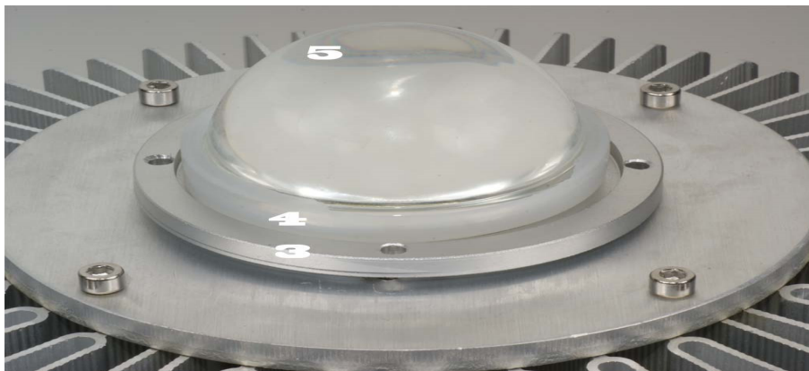
Photo 3: Cercle support en aluminium (3), cercle support en silicone (4), lentille (5)
